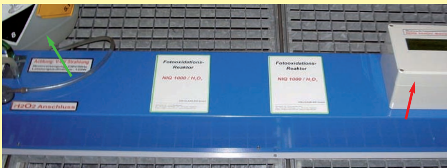
Photooxidation- und Entkeimungsreaktor (grüner Pfeil: Zudosierung von Wasserstoffperoxid, roter Pfeil: elektronische Steuerung).
